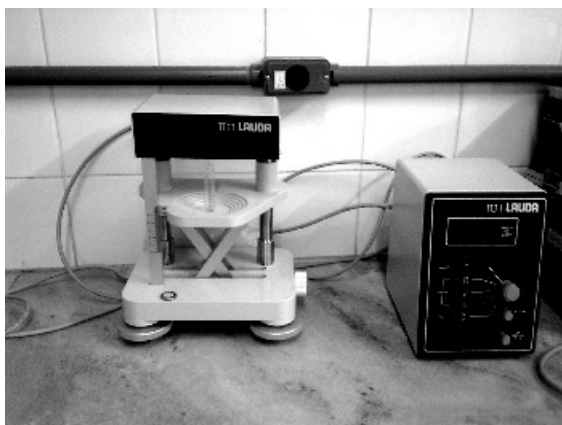
Figura 2. Tensiômetro usado nas medidas de densidade e tensão superficial.
