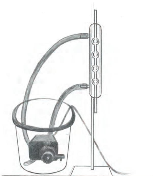
*Figura 1. Bomba de circulação ligada a um condensador.*
