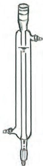
Figura 3.7. A) Condensador de vidro conhecido como condensador de Liebig, utilizado nos laboratórios atualmente. B) Uma versão do condensador de Liebig no início do século XIX.
