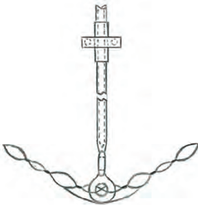
Figura 3.14. Agitador inventado por Hershberg para misturas viscosas
