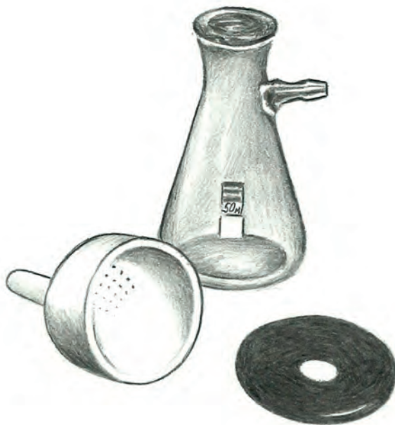
Figura 3.11. Funil de Büchner, Kitasato e argola de borracha colocada entre o Kitasato e o funil. O Kitasato possui paredes mais espessas do que um Erlenmeyer a fim de suportar a pressão reduzida.
