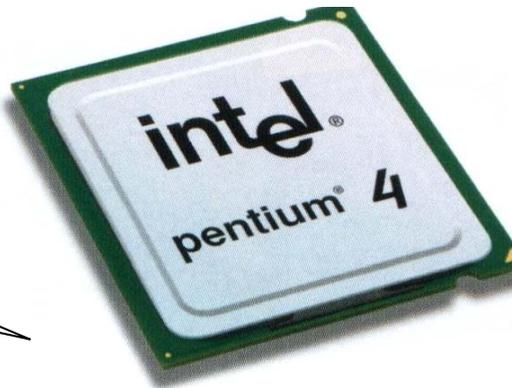
*O novo encapsulado LGA-775 da Intel elimina os pines do microprocessador, e os leva para o socket da placa mãe. (Foto cedida pela Intel)*
