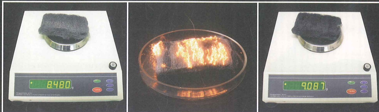
Medindo a massa da palha de aço antes e depois de sua queima, observa-se o aumento da massa do material sólido; mas, somando-se a massa do gás oxigênio que reage com o ferro, constata-se o previsto pela Lei de Lavoisier.
