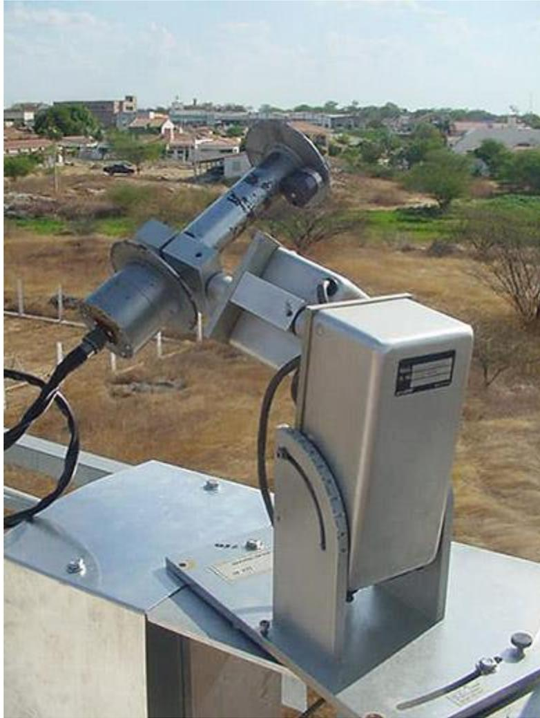
Figura 49: Pireliômetro conectado ao robô rastreador, disponível em: < [http://sonda.ccst.inpe.br/fotos/CAI/2002/caico\\_20.html](http://sonda.ccst.inpe.br/fotos/CAI/2002/caico_20.html) >, acesso em 06/05/2016.
