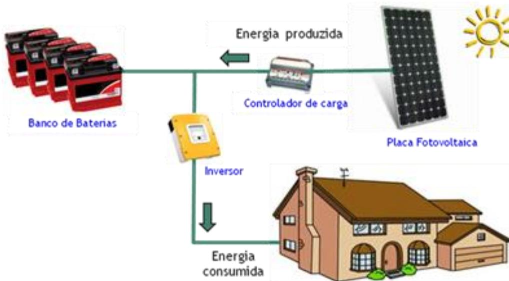
Figura 74: Exemplo de topologia de sistema fotovoltaico autônomo, disponível em: < <http://www.viridian.com.br/tecnologia/energia+solar+fotovoltaica/4> >, acesso em 14/07/2016.
