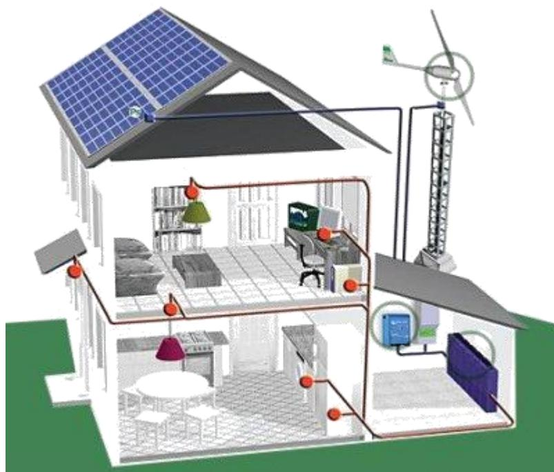
Figura 101: Sistema de geração híbrida solar + eólica em aplicações residenciais, disponível em: < <https://autosolar.es/kits-solares/kit-solar-eolico-hibrido> >, acesso em 15/07/2016.
