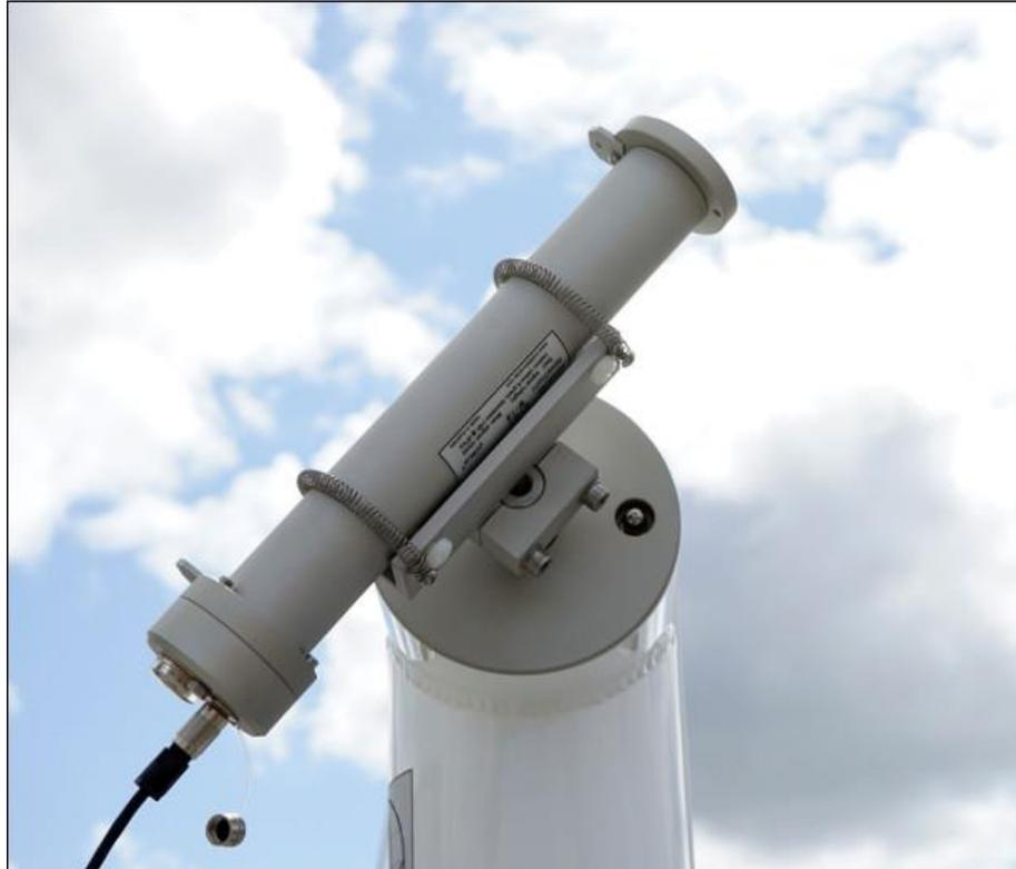
Figura 50: Pireliômetro, disponível em: < [http://recursosolar.geodesign.com.br/Pages/Pyrheliometer\\_RS.html](http://recursosolar.geodesign.com.br/Pages/Pyrheliometer_RS.html) >, acesso em 06/05/2016.
