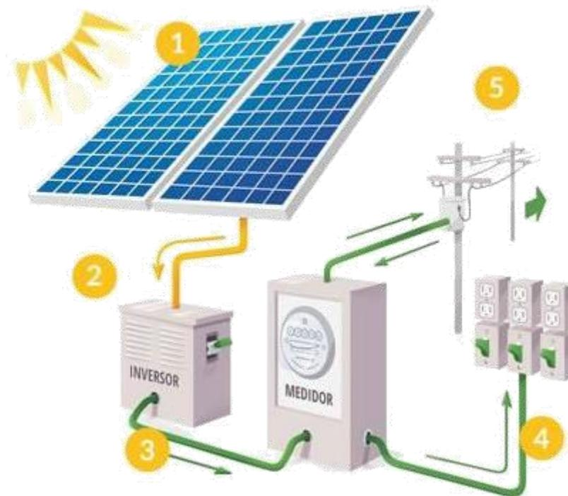
Figura 92: Sistema FV conectado à rede incluindo dispositivos de seccionamento, disponível em: < <http://www.solarcontroller-inverter.com/products/I-Panda-12V-24v-48v-Series-mppt-solar-controller-50A.html#.V20bCbgrLIU> >, acesso em 14/07/2016.
