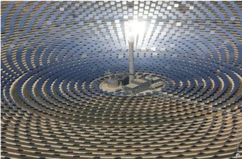
Figura 15: Vista aérea de uma usina solar térmica com concentrador do tipo torre, disponível em: < [http://img01.lavanguardia.com/2011/10/04/Vista-aerea-de-la-planta-termo\\_54226113697\\_53389389549\\_600\\_396.jpg](http://img01.lavanguardia.com/2011/10/04/Vista-aerea-de-la-planta-termo_54226113697_53389389549_600_396.jpg) >, acesso em 02/06/2016.
