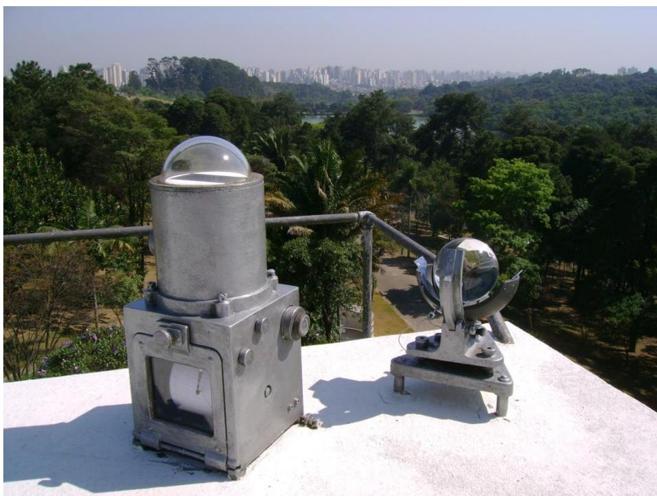
Figura 45: Actinógrafo e heliógrafo, disponível em: < <http://meteoropole.com.br/2014/02/detalhe-do-termometro-de-maxima-temperatura-e-informacoes-diversas-sobre-instrumentos-convencionais/> >, acesso em 06/05/2016.
