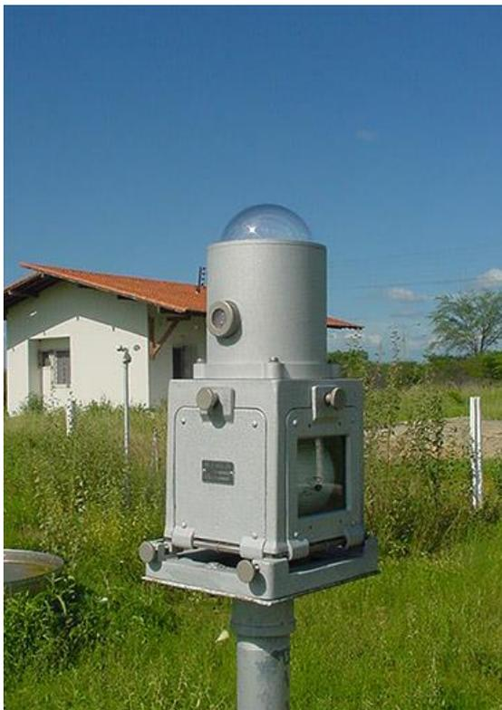
Figura 44: Actinógrafo, disponível em: < [http://sonda.ccst.inpe.br/fotos/CAI/2002/caico\\_06.html](http://sonda.ccst.inpe.br/fotos/CAI/2002/caico_06.html) >, acesso em 06/05/2016.
