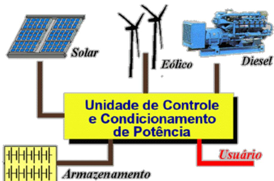
Figura 94: Topologia de sistema híbrido solar + eólico + diesel, disponível em: < [http://cresesb.cepel.br/index.php?section=com\\_content&cid=341](http://cresesb.cepel.br/index.php?section=com_content&cid=341) >, acesso em 15/07/2016.
