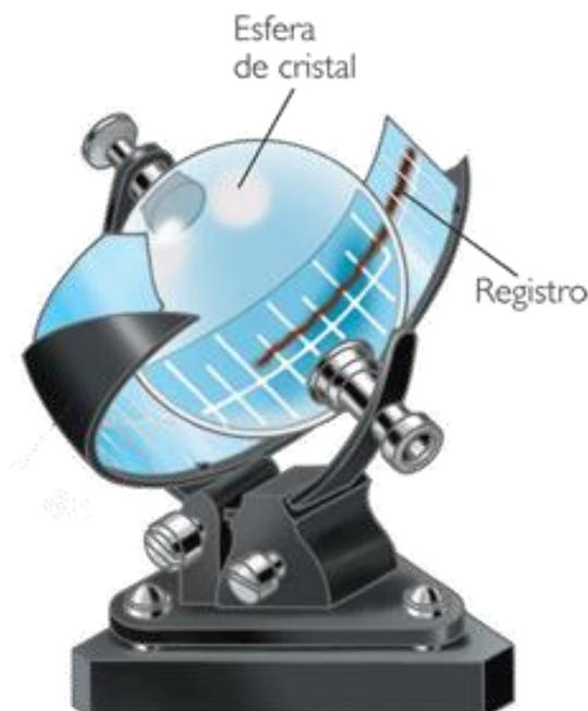
Figura 40: Aspecto visual do heliógrafo, disponível em: < <http://meteoropole.com.br/2012/03/bola-de-cristal/> >, acesso em 06/05/2016.
