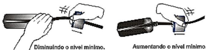
Figura 49: Exemplo de ajuste do nível máximo e mínimo da chave boia com contrapeso. Fonte: Disponível em: < [http://www.margirius.com.br/manual\\_cb.aspx](http://www.margirius.com.br/manual_cb.aspx) >, acesso em 23/11/12.
