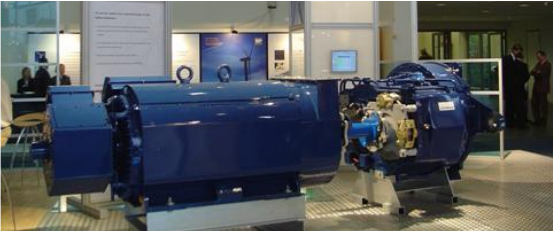
Figura 22: Gerador (lado esquerdo) acoplado a caixa multiplicadora de velocidades (lado direito).
