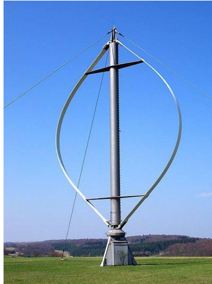
Figura 6: Exemplo de turbina eólica de eixo vertical ( onshore ).
