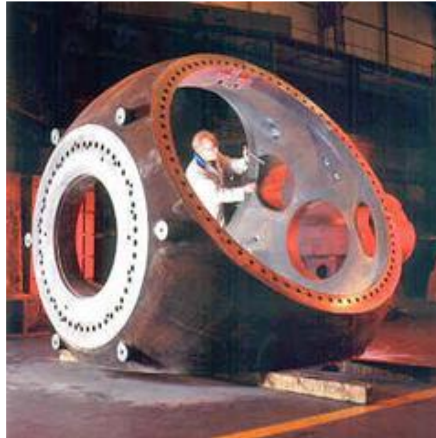
Figura 21: Exemplo de cubo de aerogerador.
