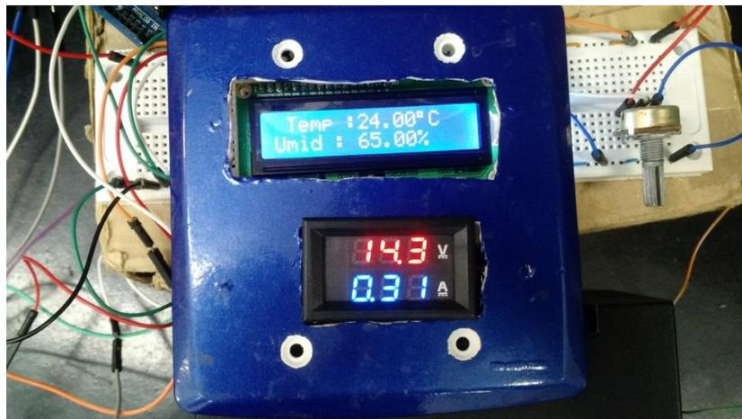
**Figura 17:** Interface gráfica do protótipo.
