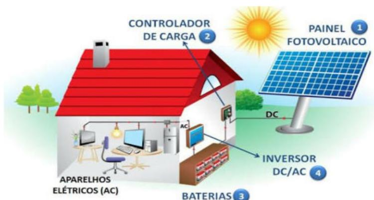
**Figura 9:** Esquema para um sistema autônomo de geração fotovoltaico. Disponível em: < <https://www.aldeiasolar.com/produtos-e-servicos> >. Acesso em: 08/03/18.
