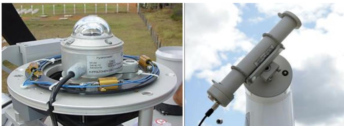
**Figura 3:** Piranômetro (a). Disponível em: < [http://sonda.ccst.inpe.br/fotos/PTR/2004/petrolina\\_83.html](http://sonda.ccst.inpe.br/fotos/PTR/2004/petrolina_83.html) >. Acesso em: 19/02/18. Pireliômetro (b). Disponível em: < [http://recursosolar.geodesign.com.br/Pages/Pyrheliometer\\_RS.html](http://recursosolar.geodesign.com.br/Pages/Pyrheliometer_RS.html) >. Acesso em: 08/03/18.
