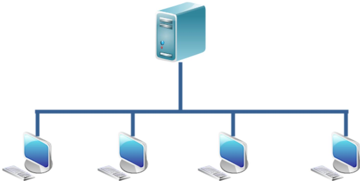
Um computador com um grande poder de processamento com a presença de “terminais burros” conectados a ele.
