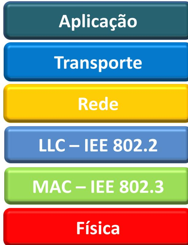
Arquitetura de uma rede utilizando a pilha de protocolos TCP/IP e o padrão Ethernet
