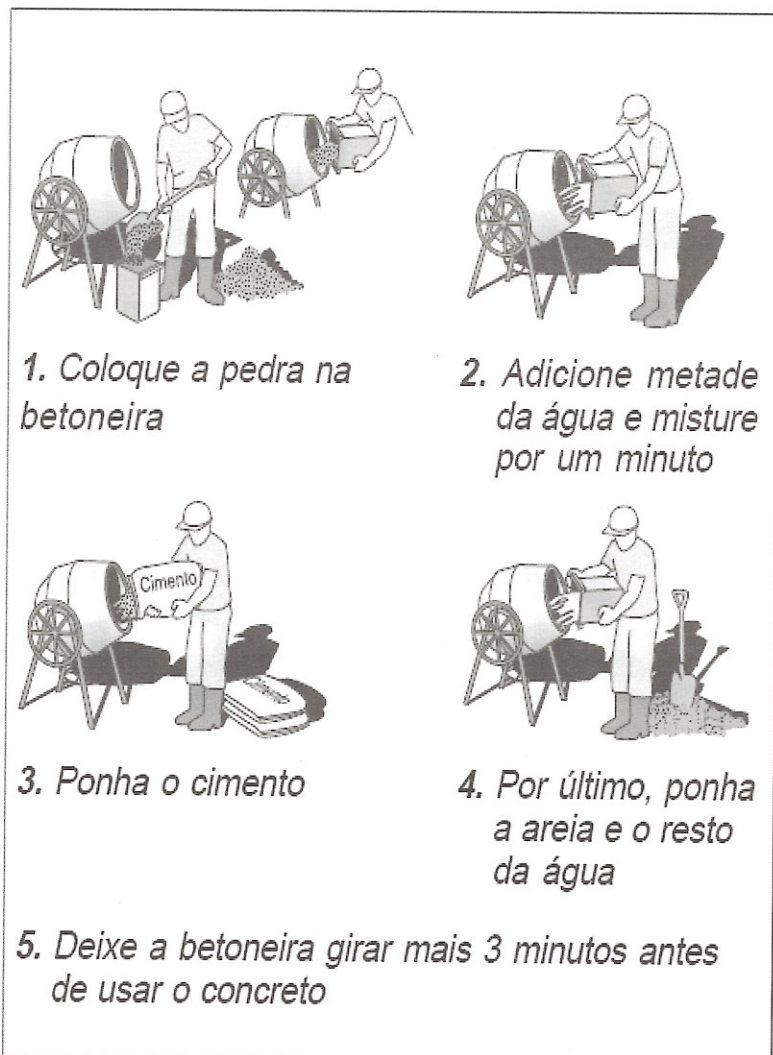
Figura 68 - Concreto misturado em betoneira Fonte: ABCP
