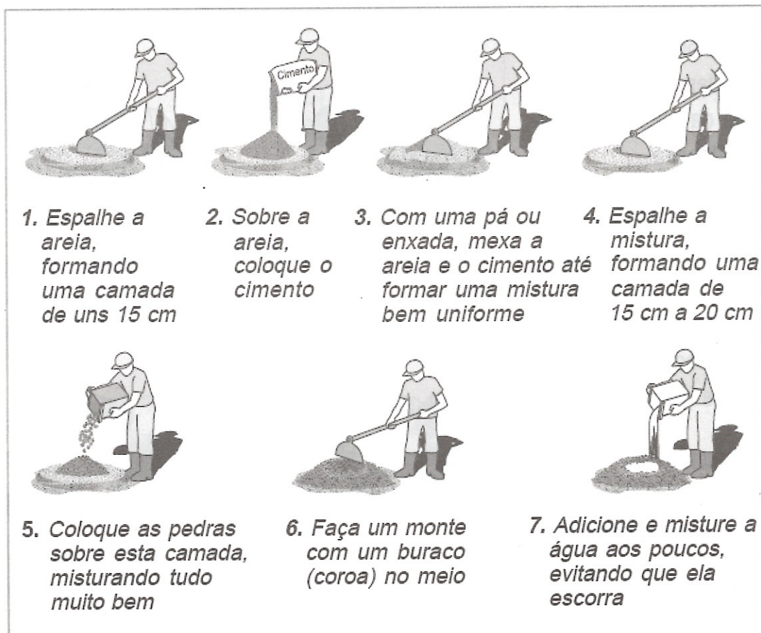
Figura 66 - Concreto misturado a mão Fonte: ABCP
