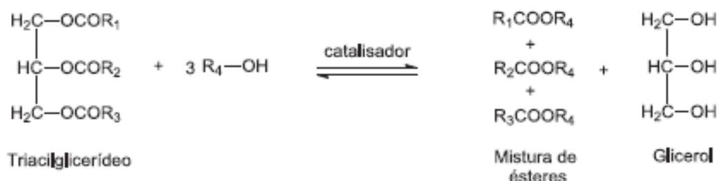
Figura 01: Equação geral de reação de transesterificação para um triacilglicerídeo. Fonte: Química Nova vol.30, n.5, 2007.
