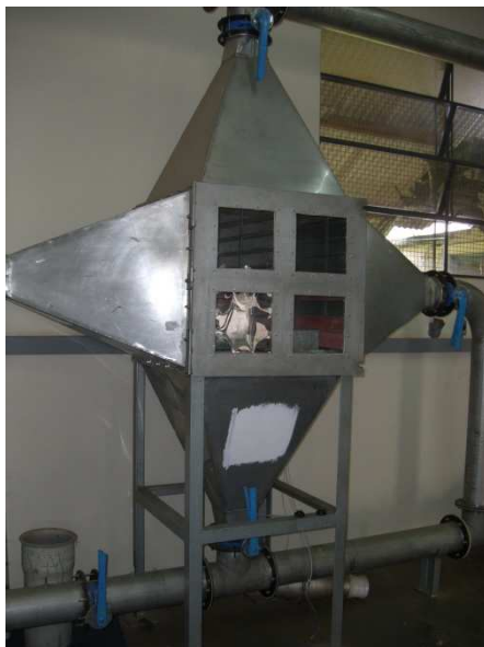
Figura 4.2 – Secador convectivo de fluxo paralelo e perpendicular.
