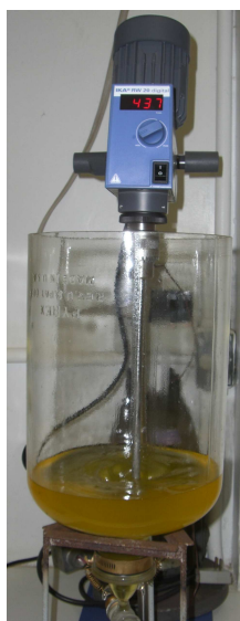
Figura 4.6 - Sistema para lavagem com água acidificada.
