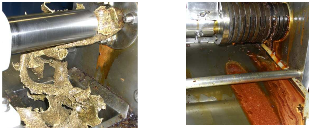
Figura 5.11 – Torta sendo eliminada durante a prensagem e recuperação do óleo.
