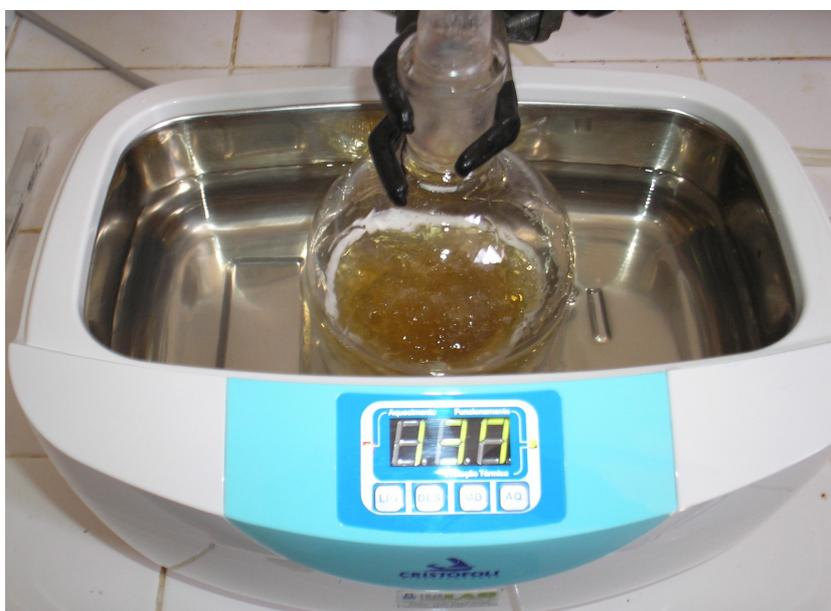
**Figura 4.5** – Reator ultrasônico.
