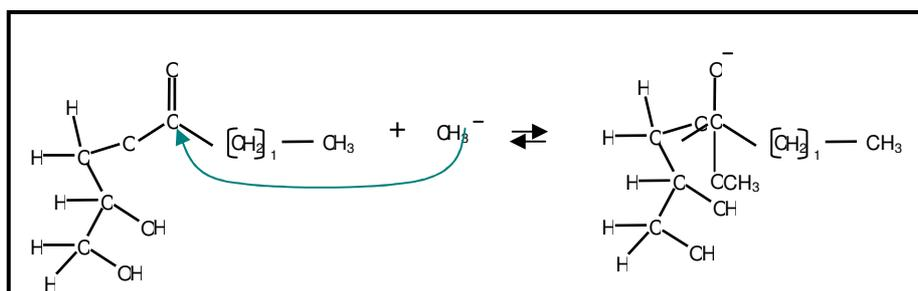
**Figura 3.8** - 2ª Etapa da transesterificação: o metóxido ataca o átomo de carbono da carbonila da molécula de monoglicerídeo (MG) para formar um intermediário tetraédrico.
