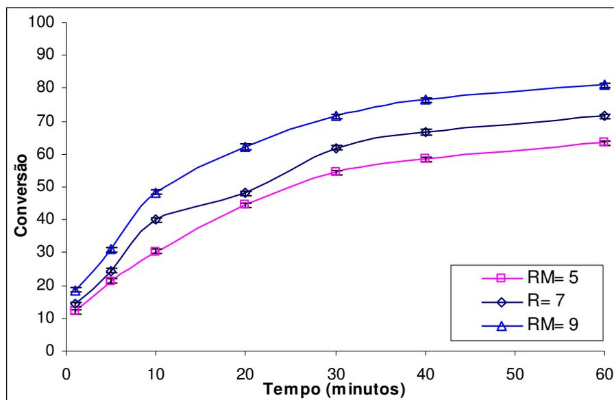
**Figura 5.23** – Avaliação do efeito da razão molar na esterificação dos ácidos graxos do óleo de soja pós-fritura para uma quantidade fixa de catalisador de 0,5 %.
