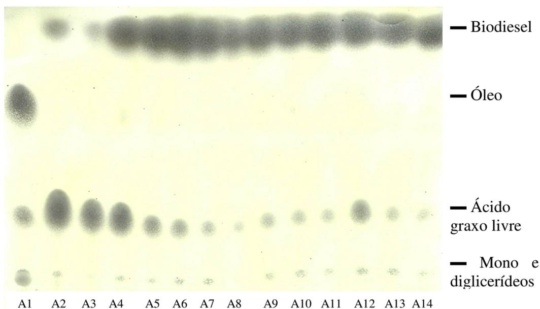
**Figura 5.19** – Cromatografia em camada delgada da esterificação dos ácidos graxos do óleo de peixe.
