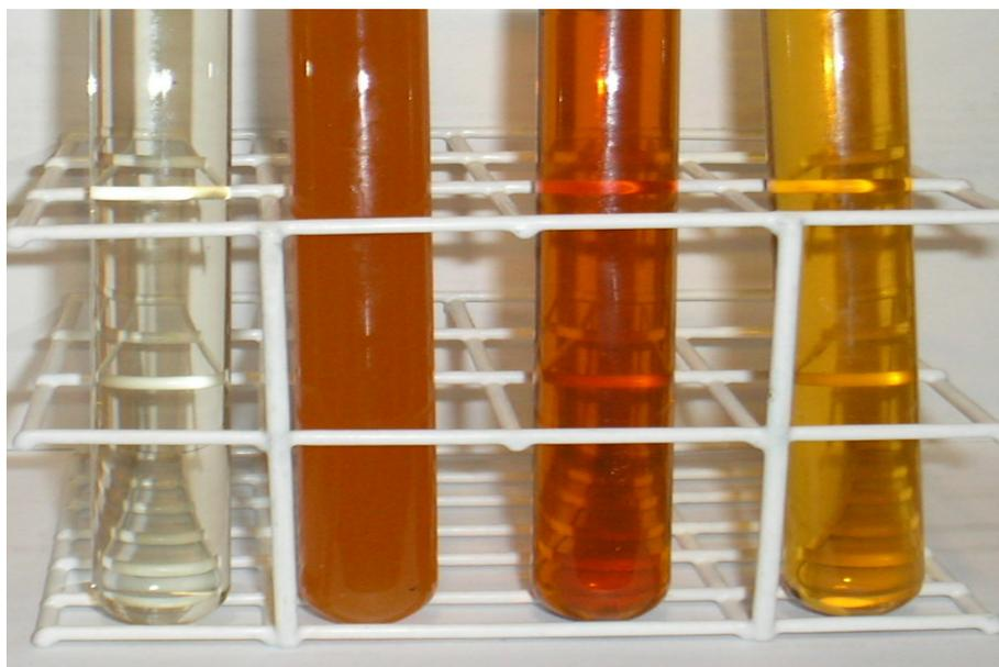
**Figura 4.4** – Óleo de soja, óleo de soja pós-fritura, ácido graxo, biodiesel (da esquerda para direita).
