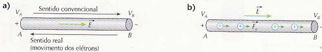
Figura 7. (a) O sentido convencional da corrente elétrica é o sentido do campo elétrico. (b) O sentido convencional é o sentido que teríamos se as cargas elétricas livres fossem positivas.
