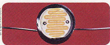
▲ Resistor foto-sensível: sua resistência elétrica varia conforme a incidência da luz.
