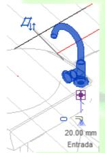
Você pode desenhar na planta de piso, corte, 3D, como desejar. Observe que os canos podem ser desenhados a partir dos ícones que surgem quando selecionamos um componente hidráulico (torneiras, pias, reservatórios, canalizações, etc.), ou através da:
