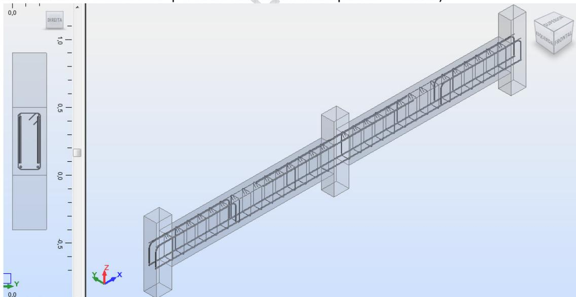
5. Detalhes da ferragem desenhados em pranchas para imprimir: barra de ferramentas 'parâmetros da viga', botão 'desenhos'. Se desejar modificar a disposição do desenho, é possível escolher entre vários layouts disponíveis. Para isso pressione na barra de ferramentas 'editar' -> o botão 'armadura' -> menu 'análise' -> parâmetros de desenho -> guia 'geral' -> modelo -> botão
