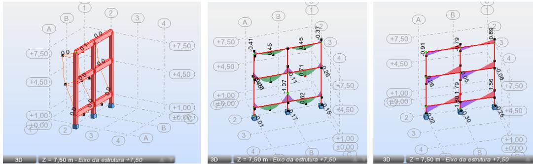
Obs.: pressione 'sair' para voltar a ver a vista completa. Para visualizar as reações nos apoios: reações -> marque 'Fx', 'Fy', 'Fz' -> aplicar.
