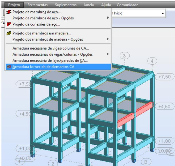
**3. Dimensionamento das ferragens:** modelo de estrutura -> início -> seleccione 2 vigas contínuas (aperte a tecla CTRL para seleccionar mais de uma) e clique no menu 'projeto' -> 'armadura fornecida de elementos CA'.
