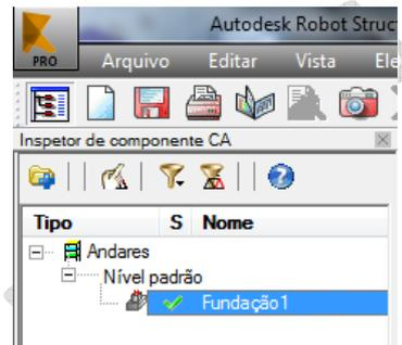
Botão armadura fornecida dos elementos de CA -> combinações manuais -> ok -> fechar -> faixa lateral esquerda 'inspetor de componentes CA' -> nível +/- 0.00 -> selecione com 2 cliques a fundação (neste exemplo foi selecionada 'fundação 15') -> zoom em tudo.
