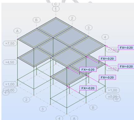
Pode-se, conforme o procedimento anteriormente usado, atribuir esses valores (definição de carga -> nó -> força nodal -> F(T) x = -0,2 -> adicionar -> clicar em cada um dos nós desejados), entretanto, também há outra forma, tanto para atribuir novos valores, quanto para alterar valores já inseridos.
