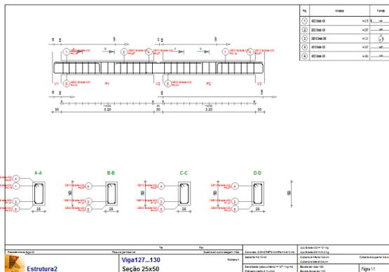
Barra de ferramentas 'parâmetros da viga', botão 'padrão da armadura' -> verifique os recobrimentos e outros parâmetros que deseje modificar (armadura principal -> diâmetro mínimo = 10; salvar como (ARM\_MODIF). Ok. Ok.
