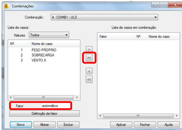
Obs.: Na janela 'combinações', se o 'fator' for deixado como 'automático', os coeficientes a serem utilizados serão os previstos nas normas utilizadas. Entretanto, pode-se alterá-los manualmente, de forma individual.
