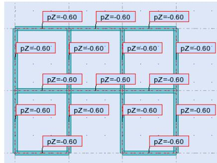
Para a altura +4,5: neste exemplo, para as vigas, continue atribuindo 0,6t. Para as lajes atribua a carga superficial uniforme de 0,5t (definição de carga -> superfície -> carga plana uniforme -> z= -0,5 (-4,9033 KN) -> adicionar -> clique em cada uma das lajes na altura +4,5m).
