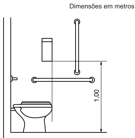
Figura 125 – Localização da papeladeira de sobrepôr (interfolhado) – Vista lateral
