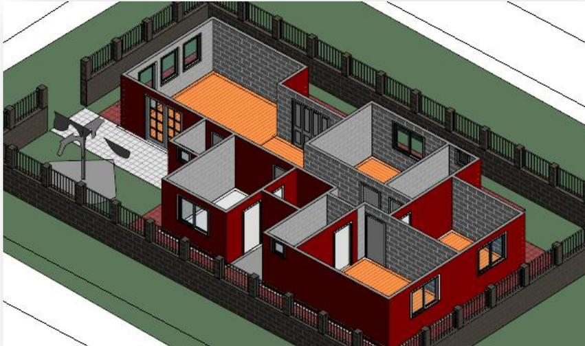
Com este corte é possível trabalhar na aplicação de materiais nas paredes internas. Na guia gerenciar > Materiais crie a pintura branca interna.
