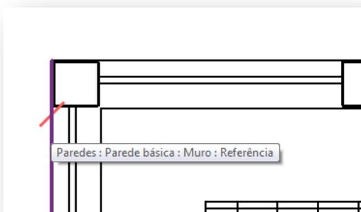
Selecione a face externa do muro e clique, leve a cota até a extremidade final do muro e clique na face externa.
