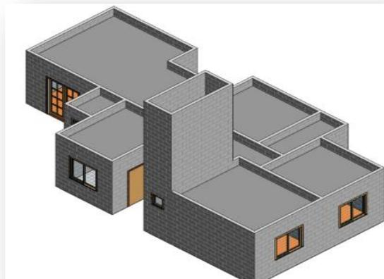
Assim como eu, acredito que somente agora você deve ter percebido que a altura da nossa caixa d'água está exageradamente alta, para isso vamos alterar sua altura. No navegador de projetos, clique e expanda a vista Elevações > Sul. Coloque o zoom na cota da caixa d'água, clique na cota e altere o valor para 4600.
