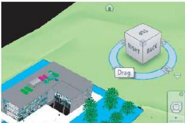
O cubo de visualização, conforme apresentado na figura ao lado permite: 1) a visualização do modelo em relação ao sistema de coordenadas do projeto e 2) selecionar pontos específicos para visualização, bem como nos demais softwares que se utilizam desse recurso. Nele, podem ser selecionadas as arestas, vértices ou faces para as diferentes visualizações que se deseja obter.
