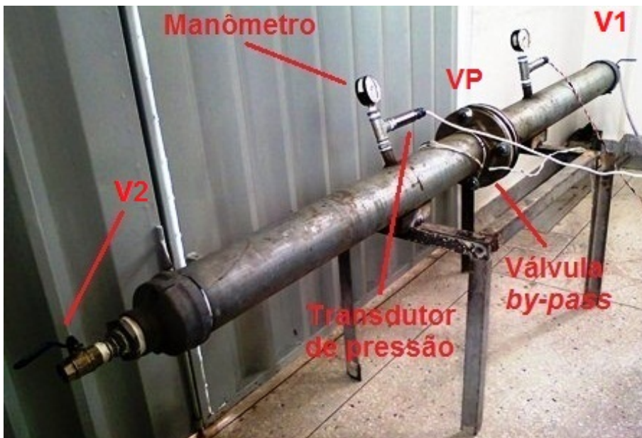
Figura 3.18: Bancada de testes para simulações de “tiro” e de aceleração.
