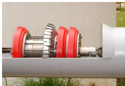
(b) Pig de corrosão.
