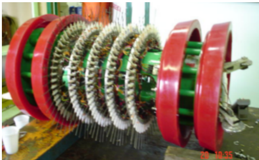
Figura 2.9: PIG palito com 250 sensores.
