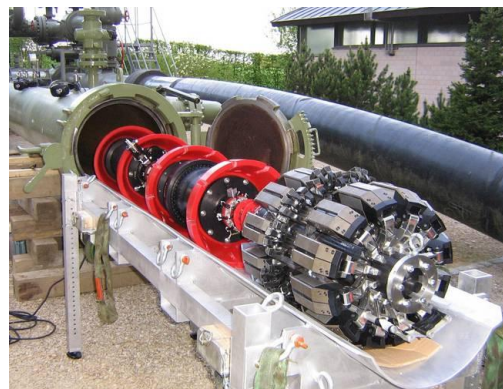
Figura 1. PIG instrumentado. (Fonte: http://www.gaznat.ch/ )
