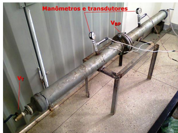
Figura 3. Bancada de testes montada para testes de “tiro”.
