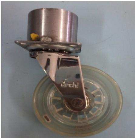
Figura 4: Protótipo do tacômetro com ímã fixado.
