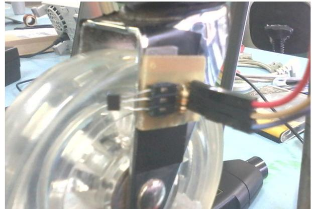
Figura 5: - Placa desenvolvida para o sensor Hall.
