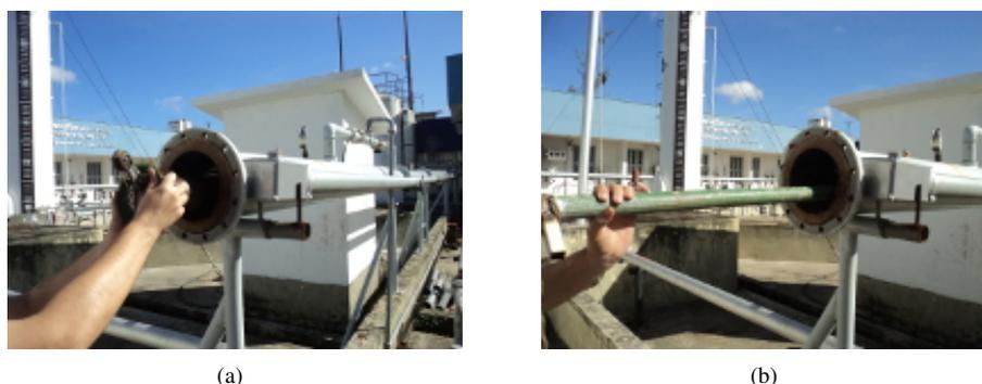
Figura 8: Preparação do Ensaio Experimental. (a) PIG protótipo Colocado; (b) PIG Protótipo Empurrado.
