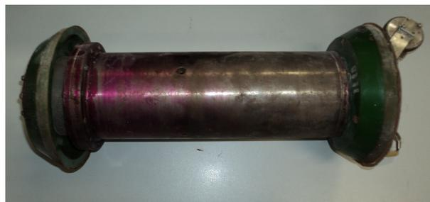
Figura 4: PIG Protótipo do LAMP.
