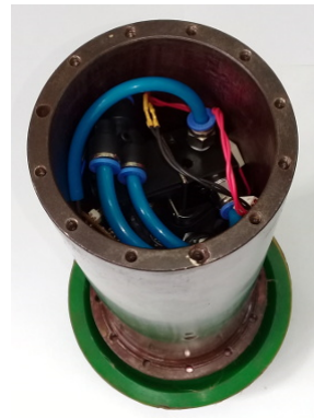
Sensor e Eletroválvula.
