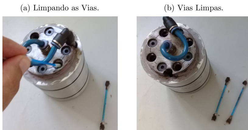
Figura 5.17: Limpeza das Vias Principais da Válvula de Desvio.
