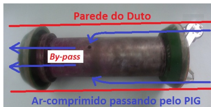
Figura 3.9: Simulação da Operação da Válvula de Desvio.
