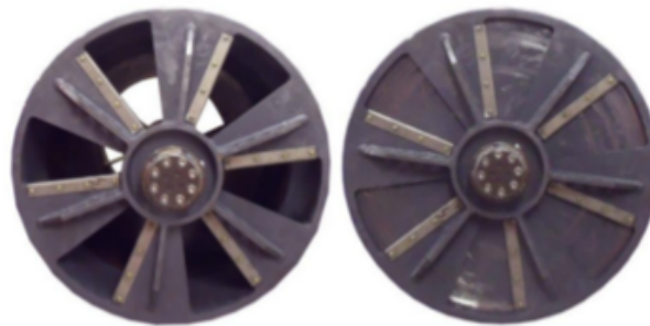
Figura 1.4: Palhetas Abertas e Fechadas da Válvula Utilizada.
