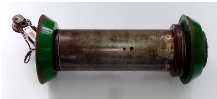
Figura 3.28: Montagem do PIG Protótipo Concluída.
