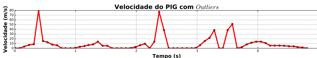
Figura 5.5: Gráfico de Velocidade do PIG Protótipo com Possíveis Outliers .
