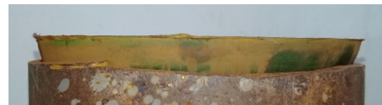
Figura 5.13: Estado dos Suportes de Poliuretano.
