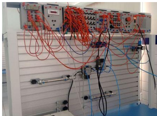
Figura 3 – Montagem do Comando Eletropneumático no Painel Didático.
