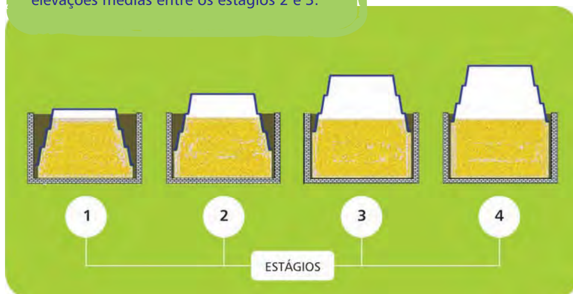
[Figura 45] Estágios de elevação da caixa de fibra. Recomenda-se que ela oscile nas elevações médias entre os estágios 2 e 3.
