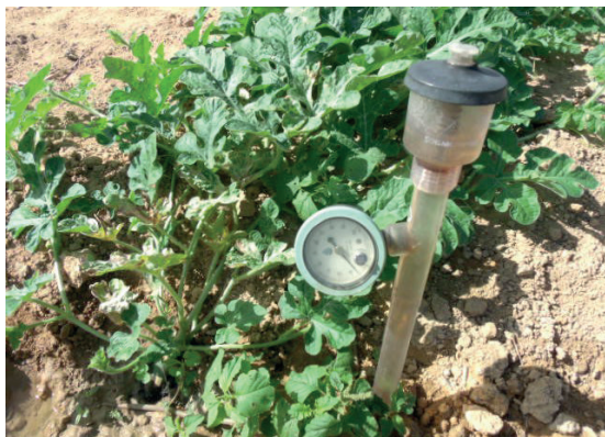
Figura 28 - Tensiômetro utilizado no controle da irrigação ( hora de irrigar).
