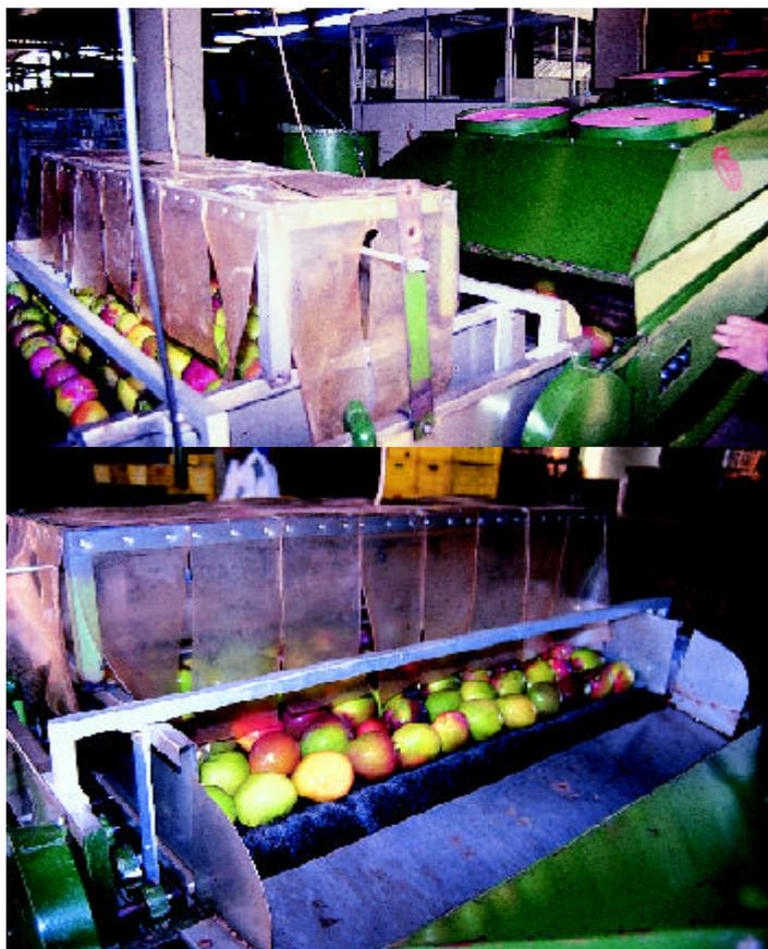
**Figura 35.** Sistema de aplicação de cera e polimento.
