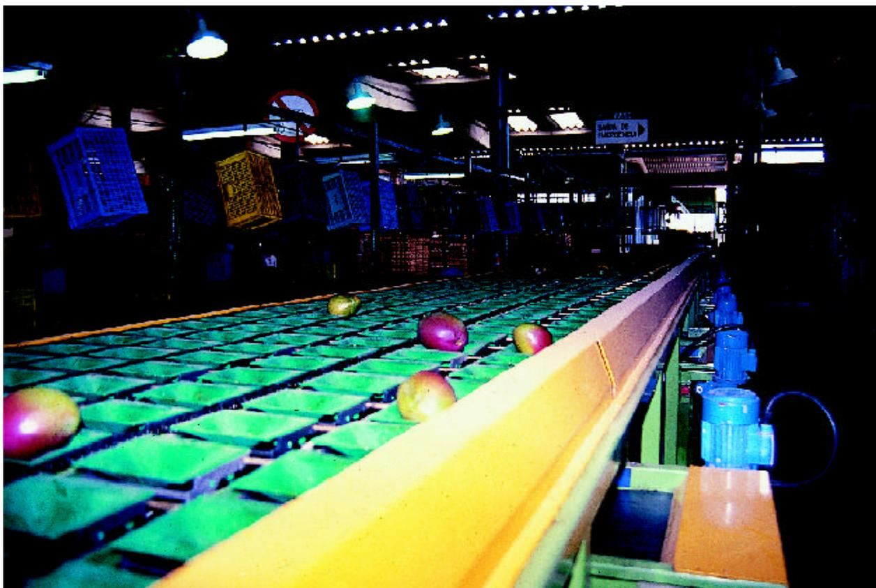
Figura 33. Seleção mecânica por peso.
