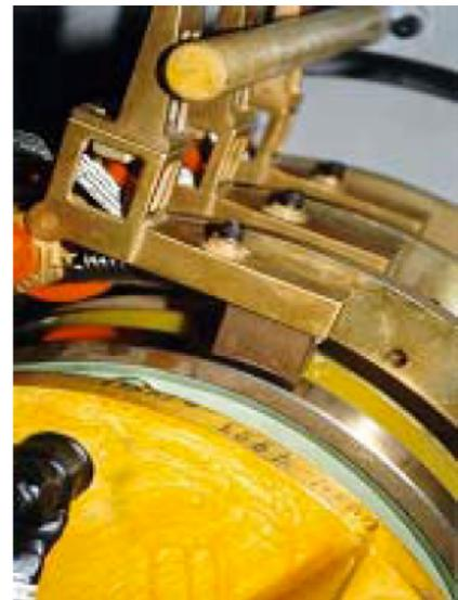
(b) Dispositivo de levantamento automático.
