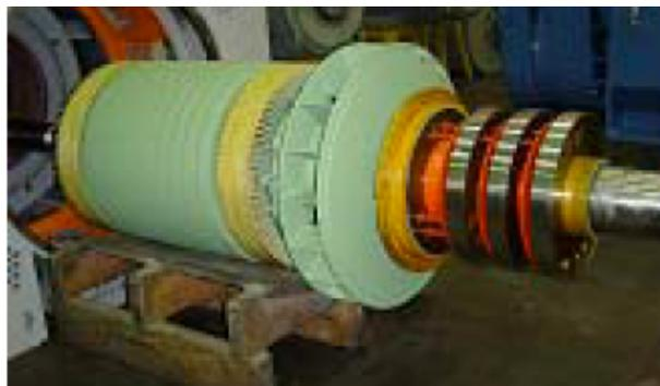
(b) Rotor tipo bobinado (ou enrolado).
