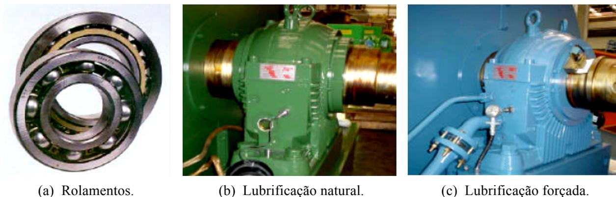
**Fig. 2-21** : Tipos de mancais utilizados nos motores síncronos.
