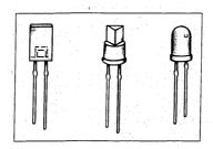
O catodo do LED é identificado por um "corte" (ou chanfro) na base do encapsulamento, ou pelo terminal menor.
