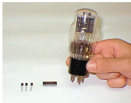
Figura 12. Transistores, integrados e válvulas
