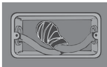
Fig. 19 – Colocando a emenda dentro da caixa
