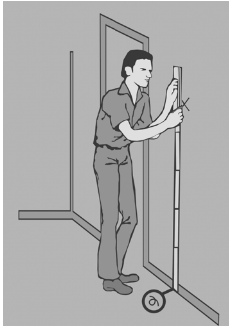
Fig. 15 – Marcando a posição do interruptor
