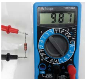
Figura 179 - Teste com resistor na escala correta
