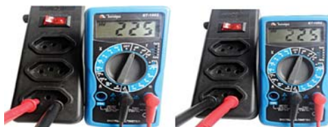
Figura 178 - Multímetro digital em medição de tensão alternada
