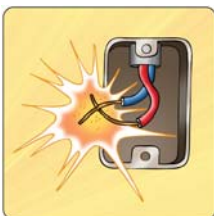
Figura 48 - Função básica do disjuntor
