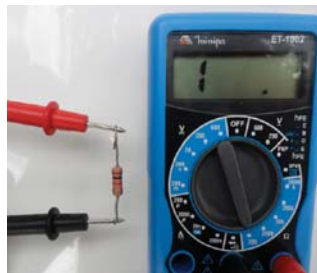
Figura 180 - Medida de resistor na escala abaixo do valor da resistência.
