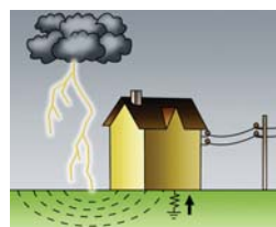
Descarga próxima a edificação (por potencial de terra)
