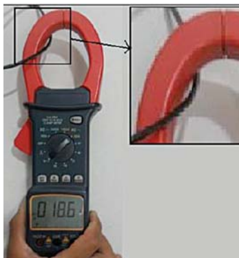
Figura 182 - Utilização do Alicate amperímetro
