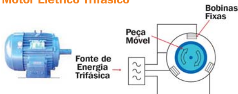
Figura 26 - Princípio de Funcionamento do Motor Elétrico Trifásico
