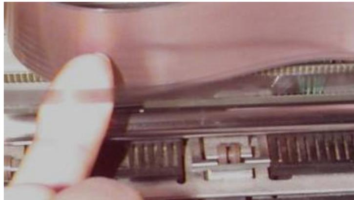
Se por acaso a impressora estiver fazendo ruídos, como se o carro de impressão estivesse raspando em algo, experimente limpar e lubrificar o eixo da impressora. Para isso o mais recomendável é graxa de silicone, que é o material que os próprios fabricantes utilizam. Na falta, uma segunda opção seria usar óleo automotivo, mas em pequena quantidade. Outra opção seria simplesmente deixar o eixo bem limpo, sem nenhuma lubrificação especial, o recomendado por alguns fabricantes.
