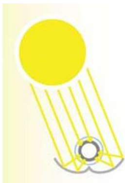
Ilustração 5: Esquema de funcionamento e vista ampliada de um coletor CPC
