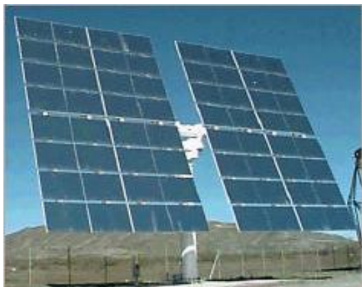
Ilustração 22: (a) Vista de um heliostato típico (GM-100);(b) Mecanismo de acionamento (SENER)
