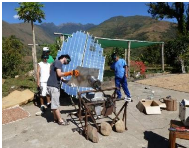
Ilustração 15: Ajuste de um dispositivo solar para secagem de café, no Peru ( http://www.energias-renovables.com )
