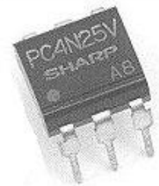
ASPECTO REAL DE UM FOTOACOPLADOR DE 6 TERMINAIS
