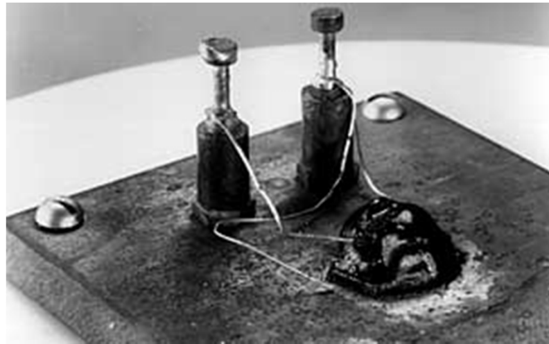
Figura 1 - O primeiro transistor de junção de germânio da Bell Laboratories, 1950
