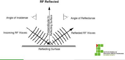
Não existem condutores perfeitos, a reflexão nunca é completa. Condutores menos eficientes absorvem um pouco da energia das ondas e em alguns casos, a onda penetra na superfície refletora.
