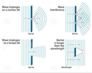
Por trás do obstáculo se formará uma zona de interferência (onde as ondas se sobrepõem, podendo tanto se reforçarem como se cancelarem), enquanto que a parte desobstruída do bordo anterior da onda prossegue em sua direção original.
