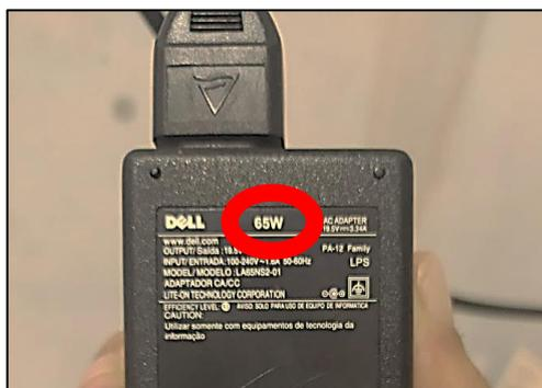
Em alguns aparelhos, a potência não vem em KW, mas sim em watts (W), neste caso, é preciso dividir a potência em watts por 1000 para poder ter a mesma potência, em KW, já que  $1000w = 1 Kw$ .
