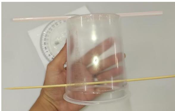
Depois, é só encaixar o copo na tampa. Com isso, o Teodolito está pronto para ser utilizado e deve ficar de forma semelhante ao da figura abaixo:
