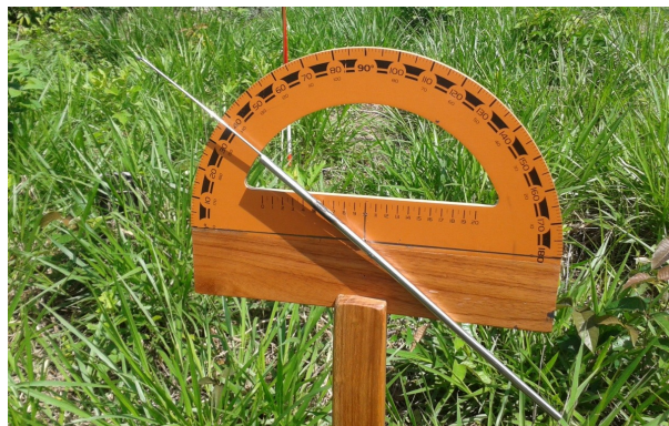
Figura 3.9: Versão final do Teodolito Caseiro construído pelos autores.
