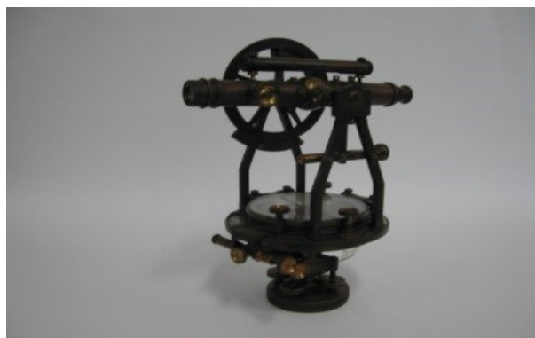
Figura 3.4: Teodolito com quatro parafusos niveladores
