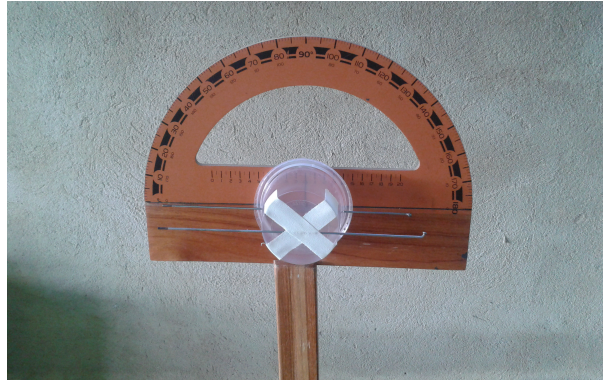
Figura 3.8: Teodolito com a regua e raio da antena fixada com solda;
