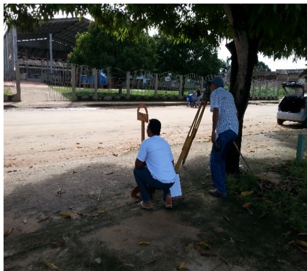
Figura 4.13: Altura da torre calculada com os teodolitos caseiro e profissional
