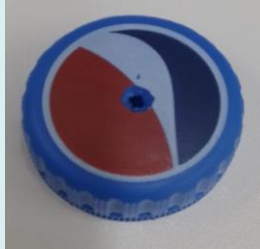
Figura 7: Furo na tampa na garrafa PET
