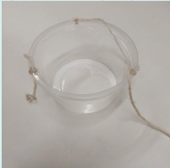
Figura 8: Furos e fixação dos barbantes nos recipientes que serão os pratos da balança
