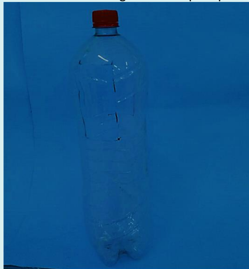
Figura 6: Orifícios abertos na garrafa PET para passar o bastão
