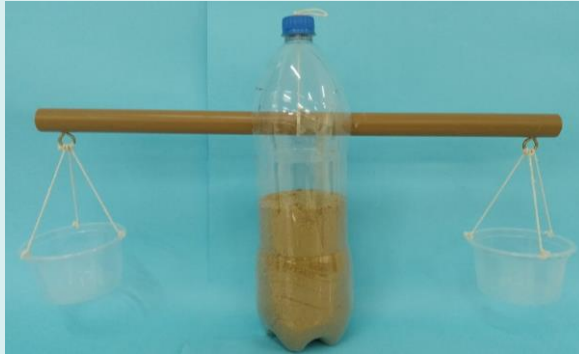
Figura 9: Montagem da balança de dois pratos usando cano de PVC
