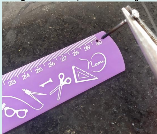
Figura 14: Realização do furo na régua
