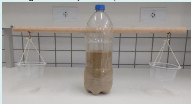
Figura 10: Montagem da balança de dois pratos usando cabo de vassoura
