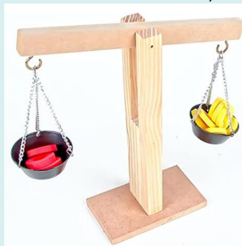
Figura 2: Balança confeccionada em madeira e MDF, 1 base de sustentação (para bandejas), 2 bandejas metálicas 6 cm de diâmetro; medida total: 23 x 7 x 25 cm.
