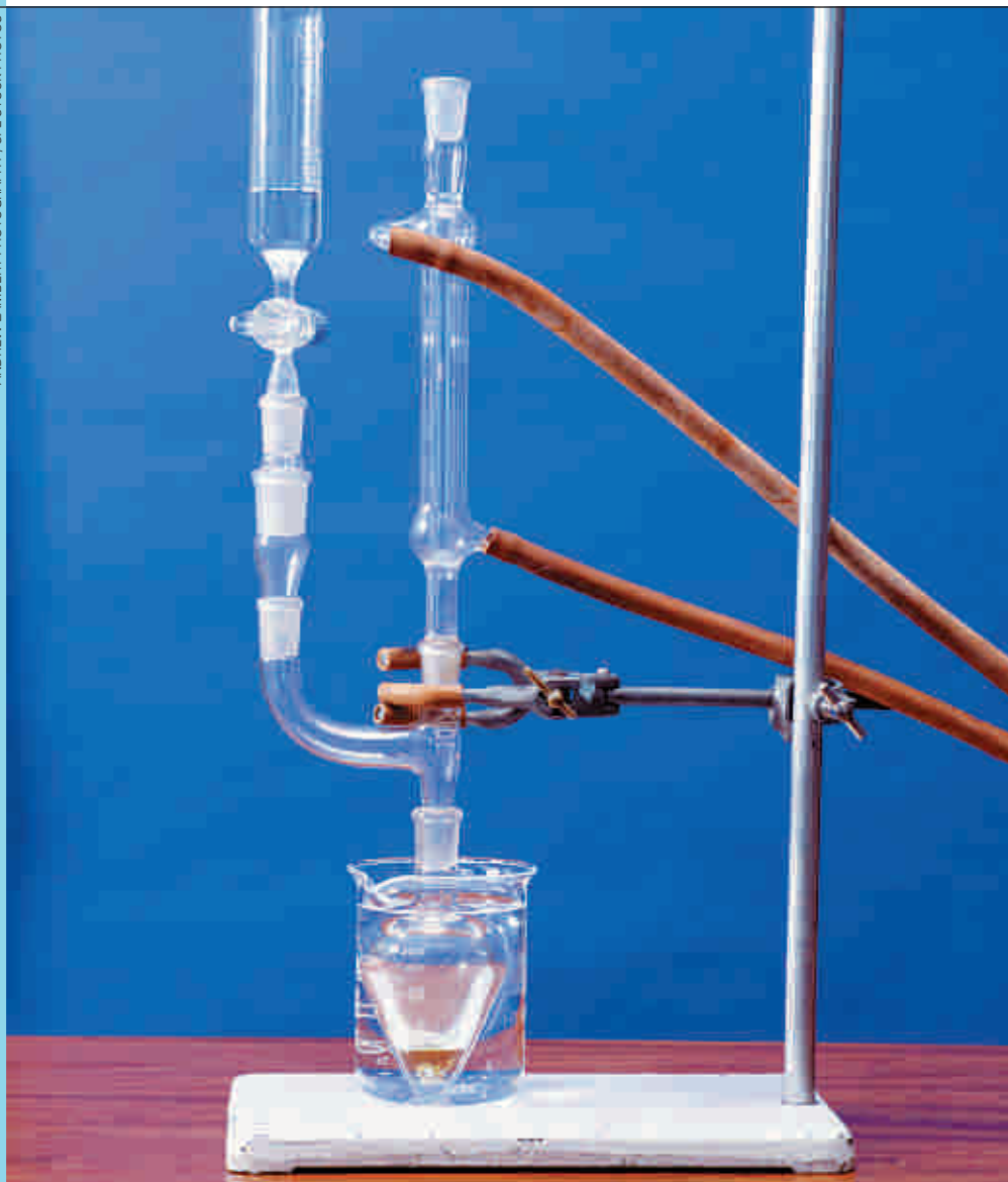
Aparelhagem utilizada para executar reações exotérmicas.
