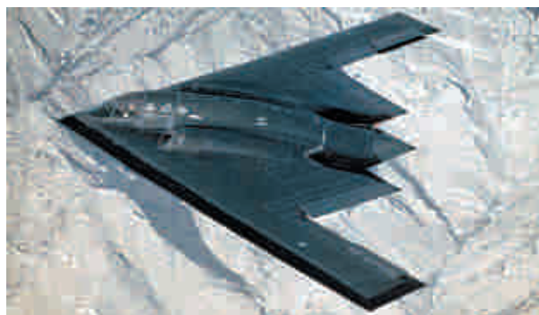
O revestimento do avião "invisível" B-2 (aparelho militar construído pelos norte-americanos) recebe um tipo especial de compósito, que absorve as ondas de radar. Assim, é quase impossível que esse avião seja detectado por radar.
