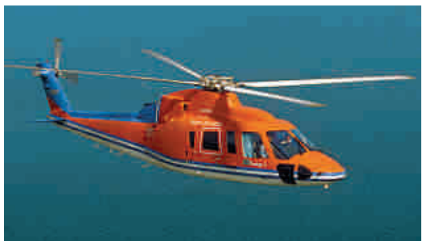
As pás dos rotores dos helicópteros são feitas de compósitos.
