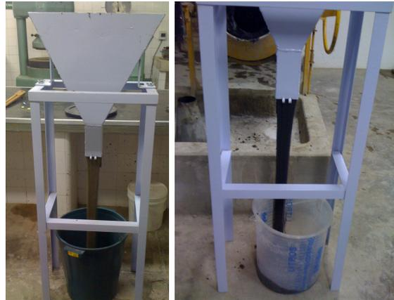
Figura 4 – Ensaio de V-test nos traços MV-CIM e 20CBC-CIM
