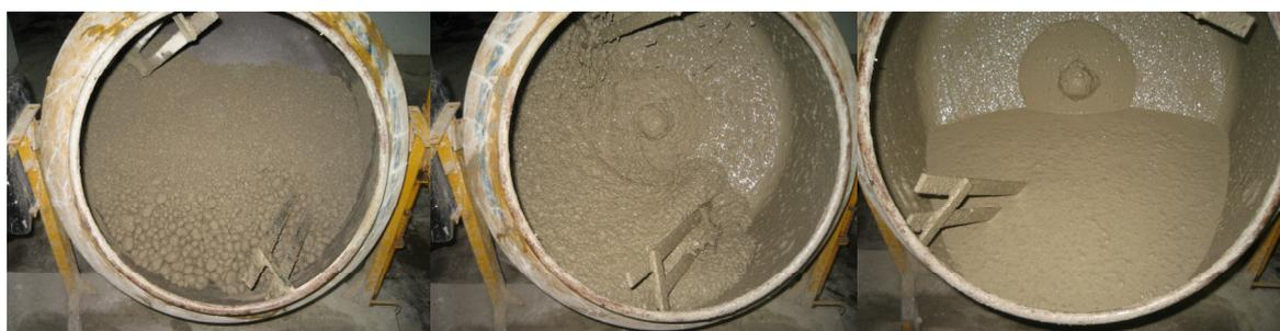
Figura 3 – a. concreto sem adição antes da colocação dos aditivos. b. concreto com adição de aditivo plastificante. c. concreto com adição de aditivo plastificante e superplastificante.
