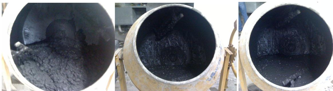
Figura 2 – a. concreto com CBC antes da colocação dos aditivos. b. concreto com adição de aditivo plastificante. c. concreto com adição de aditivo plastificante e superplastificante.
