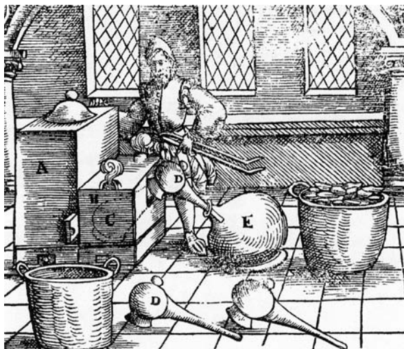
Figura 11 ■ Destilação de aqua regia * (mistura 3:1 de HCl e HNO 3 ) (Ercker, vide Fig. 4). Essa “água real” é capaz de dissolver o ouro. (Vide, na Seção VIII, o ensaio “A química do ouro é nobre, mas não é simples”.)
