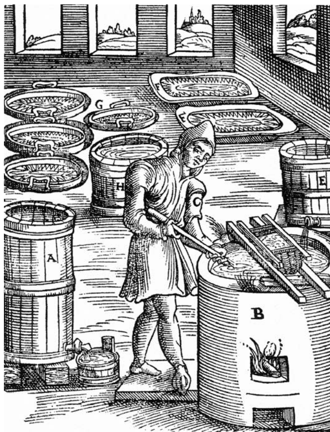
Figura 16 ■ Tinhas e barris de lixívia concentradas de salitre (vide Fig. 15). Cem libras do concentrado produzem cerca de 70 libras de salitre (Ercker; vide Fig. 4).
