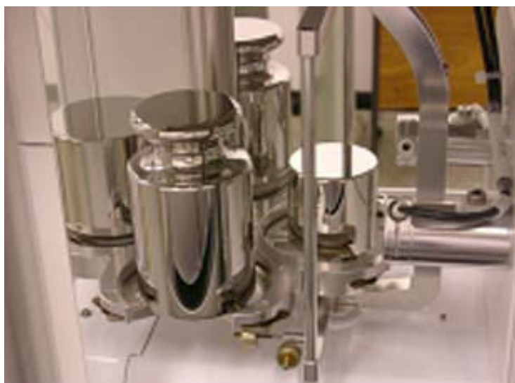
Figura 1: Equipamentos de referência e serviços de calibração e de medição do Lamas/Inmetro. Disseminação da escala de massa a partir do protótipo de um quilograma padrão de Pt-Ir. REFERÊNCIA: www.inmetro.com.br
